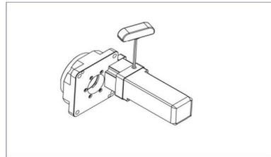
將馬達與轉接法蘭位置調整好并輕輕旋緊緊固螺栓,直至鎖環不再空轉。
