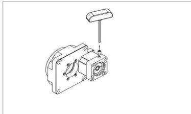
拆下轉接法蘭上的螺旋塞,然後調整位置,直至能夠看到緊固螺栓。<sup>1)</sup>
