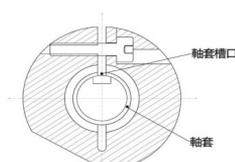
帶軸套的安裝方法
