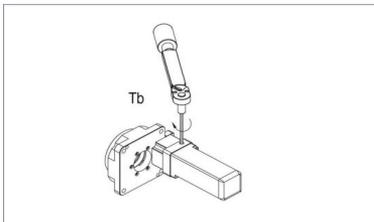
參照緊固扭矩標準Tb, 旋緊緊固螺栓。
