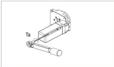
參照緊固扭矩標準Ta, 旋緊緊固螺栓。
