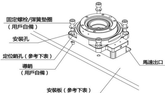
如何在中空旋轉平臺上安裝負載使用中空旋轉平臺上的6處安裝螺孔安裝負載。中空旋轉平臺上有2個安裝負載用的銷孔，可用于確定負載的位置，務必將定位銷牢固固定的負載上。
