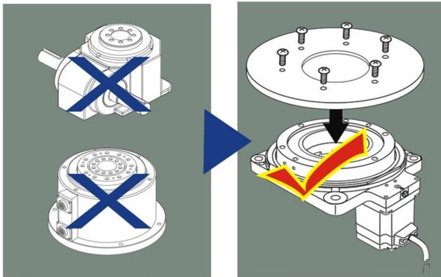
■ 通過直接連接可提高可靠性,降低成本可直接將需裝置的工作臺及機械手臂安裝在旋轉平臺上,與使用皮百足之蟲輪等機械零件相比,可減省機械設計,零件調配,皮帶狀態調整等環節耗費的時間費用。
